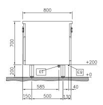
Electrical inlet (power) Equipotential screw
